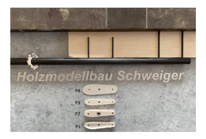
Das Pylonteil P1 kann jetzt aufgesteckt und verklebt werden. Beim Bauteil P2 darauf achten, dass die M3 Mutter nach unten zeigt. Bauteil P2 und P3 ebenfalls aufstecken und verkleben. Nur das Bauteil P4 darf noch nicht verklebt werden, da dies erst später mit dem Höhenruder geschieht. Die Kohlestäbe, die aus dem Pylon für das Höhenruder oben hinausragen, sollten auf 4mm gekürzt werden (so, dass sie mit dem aufgeschraubten Höhenruder nicht mehr hervorstehen).
