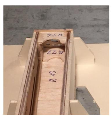
Nachdem nun auf beiden Rumpfseiten die Teile R25 kleben, gehört das Teil R27 auf den Rumpfboden und das Teil R26 auf die Rumpfoberseite. Die Teile R25 bis R27 sind dafür da, um später den Rumpf sauber an den Spinner anpassen zu können. Auf die Rumpfoberseite wird das Balsateil R17 zwischen Kabinenhaubenöffnung und Motorspant geklebt, hier verläuft die Holzmaserung quer.
