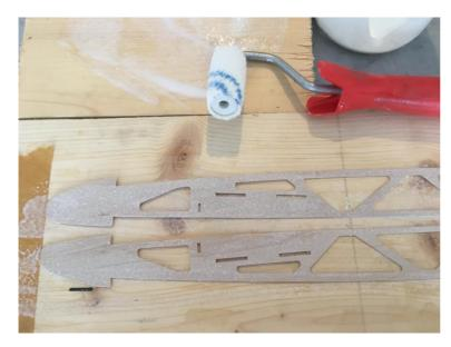
Wie auf Bild 3 zu sehen, verwenden wir für das Verkleben von R9 und R10 einen Roller. Somit kann der Leim gleichmäßig dünn aufgetragen werden. Die Teile anschließend für mehrere Stunden zusammen pressen.
