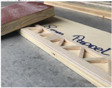
Wie auf dem Bild zu sehen, legen wir das Ruder auf ein 8mm starkes Sperrholz. Beim anschließenden Verschleifen des Ruders mit einer Schleiflatte ist jetzt darauf zu achten, dass die Schleiflatte auf der Endleiste des Leitwerks und der Tischkante aufliegt. So schleifen wir die Endleiste bis auf unsere Hilfslinie von beiden Seiten (ca. 1mm) spitz zu.
