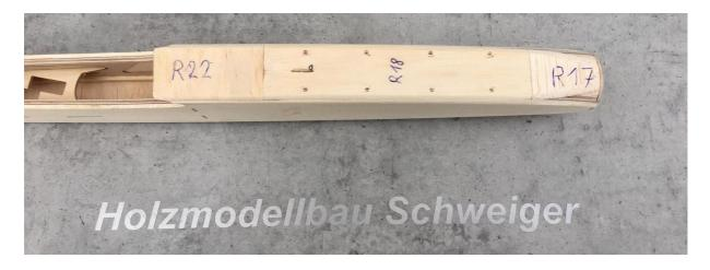
Anschließend wird auf die Rumpfbeplankung R22 das Teil R20 mittig geklebt und zusammen mit der Kabinenhaube in der Kabinenhaubenöffnung im Rumpf eingepasst.
