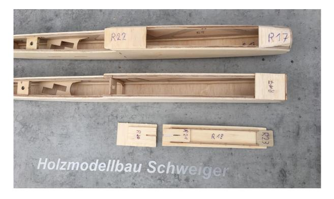
Das Sperrholzteil R23 wird innen in die Kabinenhaube zur Rumpfspitze mittig eingeklebt und dient dabei als Zunge. Das Balsateil R21 wird an das Ende der Kabinenhaube zwischen die
